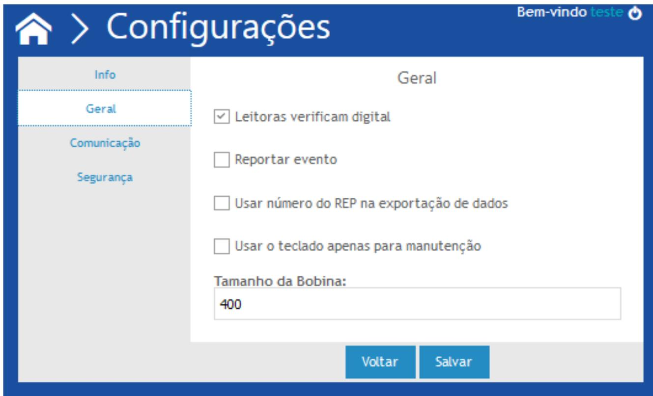
Leitoras verificam digital - Quando for um equipamento biométrico esta opção faz com que seja solicitada a confirmação da identificação através da biometria quando a entrada é com cartão;
